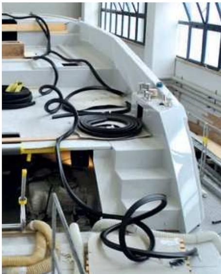
I profili QBE sono costituiti da 2 moduli: una base e un inserto.
